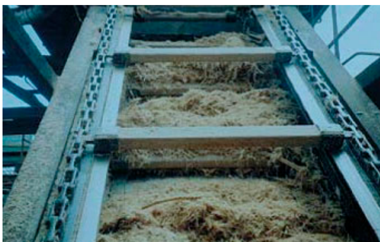
Figura 4. Conductor de tablillas.
