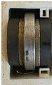
**Figura 9.** Estructura magnética básica del equipo.
