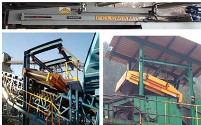
Figura 5. SM sobre colchón de la firma MAGNETIC DRUM.
