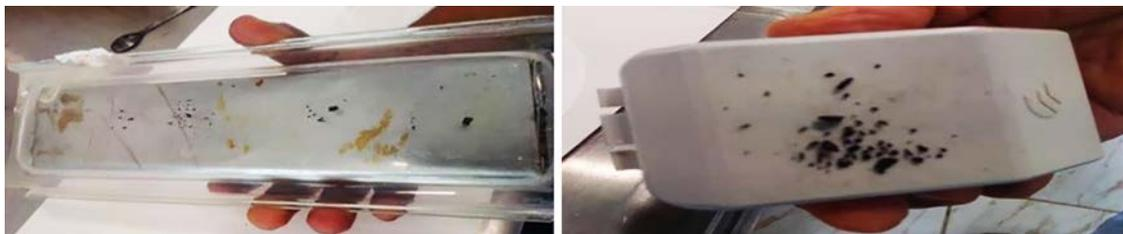
**Figura 14.** Distribución y extracción de las ferropartículas, debido al campo magnético generado por las fuentes mejoradas del Ferrolab, para distintos grados de contaminación.
