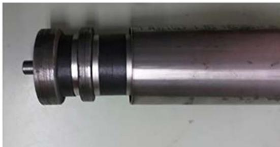
**Figura 10.** Una de las barras del separador magnético.
