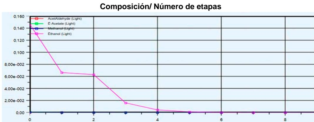
**Figura 8.** Perfil de composición de la columna T-101.
