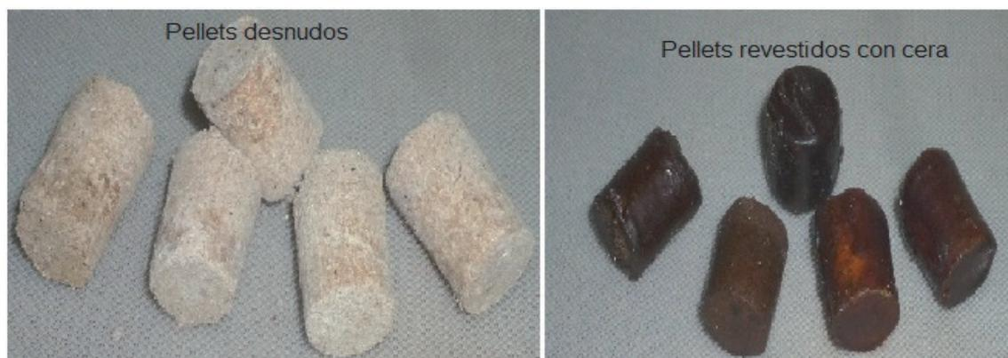
**Figura 1.** Pellets rodenticidas formulados en este trabajo.
