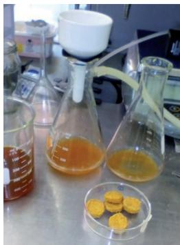
**Figura 5.** Proceso de filtrado para la extracción de LIG de bagazo integral.
