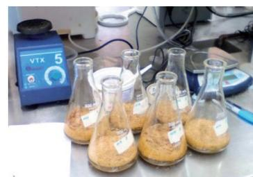
**Figura 1.** Muestras de bagazo integral para la extracción de lignina.
