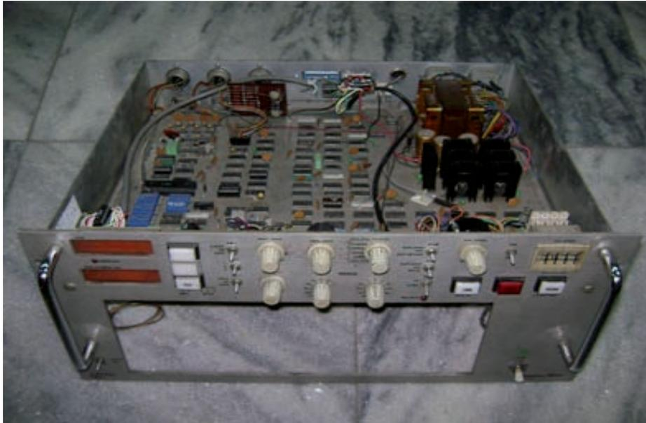
**Figura 3.** Unidad de Control del Alwetron TCT-10.
