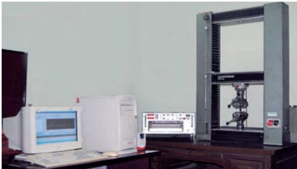
**Figura 1.** Dinamómetro universal Alwetron TCT-10 acoplado con una PC.
