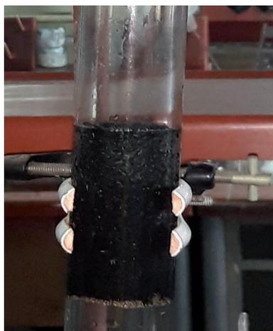
**Figura 1.** Filtro a escala de laboratorio diseñado a partir del escalado inverso de un filtro industrial.
