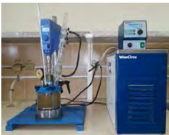
Figura 1. Instalación experimental para la obtención de azúcar invertido por hidrólisis enzimática.
