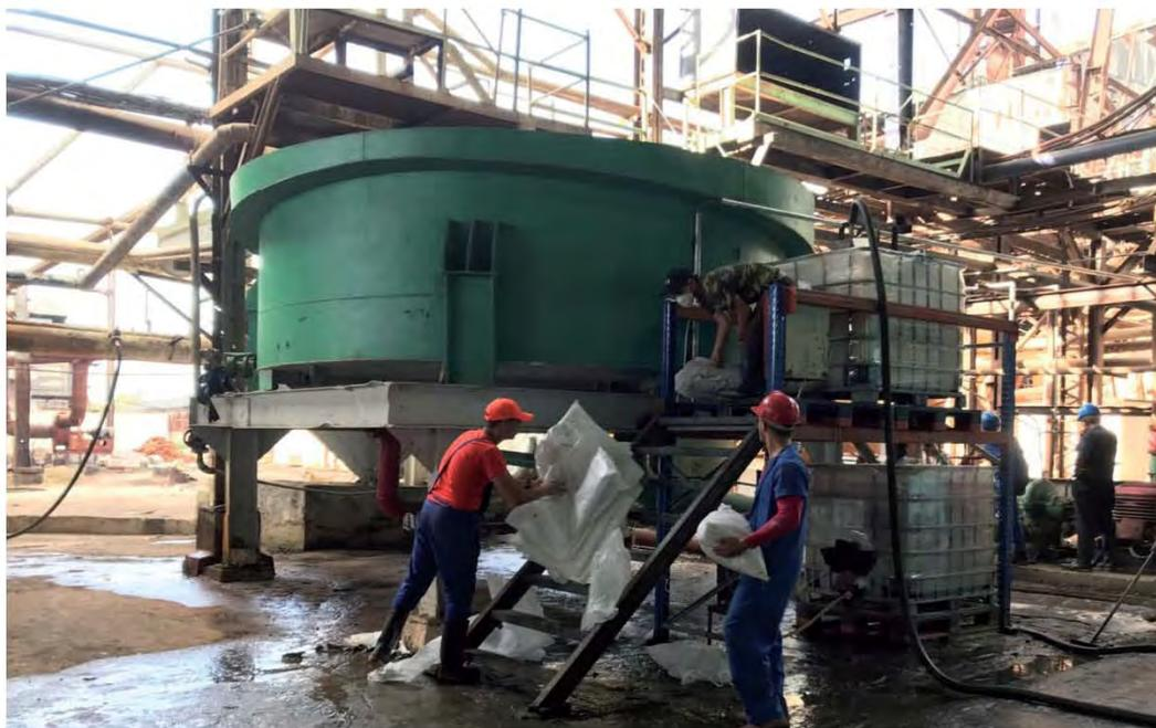
**Figura 1.** Instalación para la preparación y dosificación del GS.
