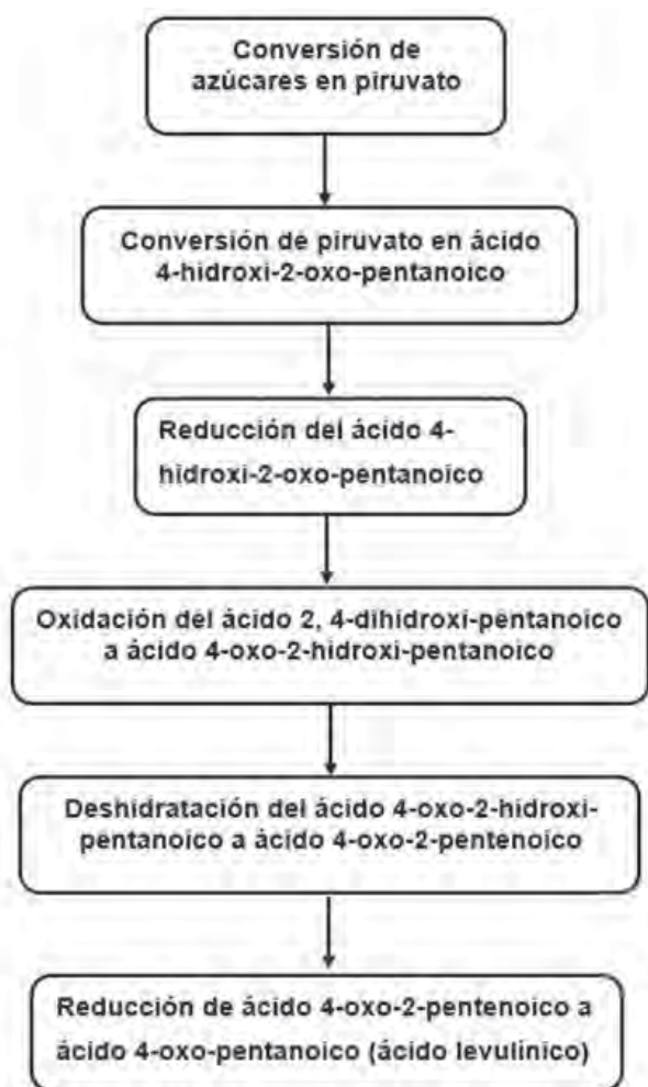
Figura 6. Diagrama de bloques del proceso por hidrólisis enzimática.
