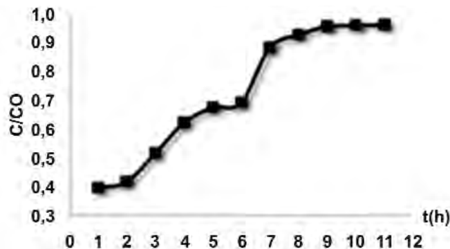
Figura 4. Curva de ruptura para una columna (H/D=6,15) rellena con BN y concentración de hidrocarburo inicial de 1444 mg/L.
